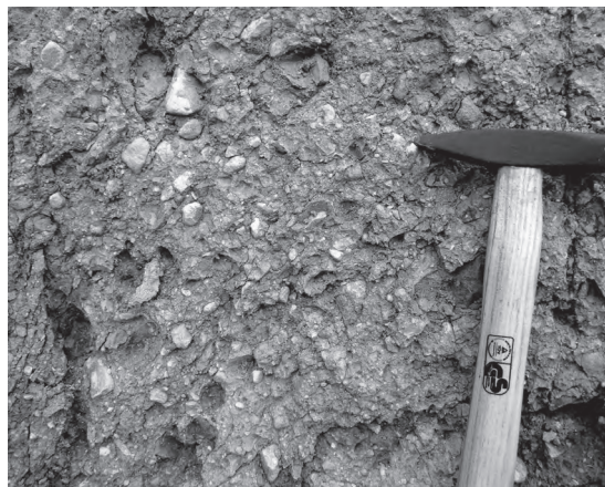
Fig. 1 - Tipico aspetto della breccia d'esplosione affiorante in prossimità dell'imbocco della galleria bassa alla Pesciara.
