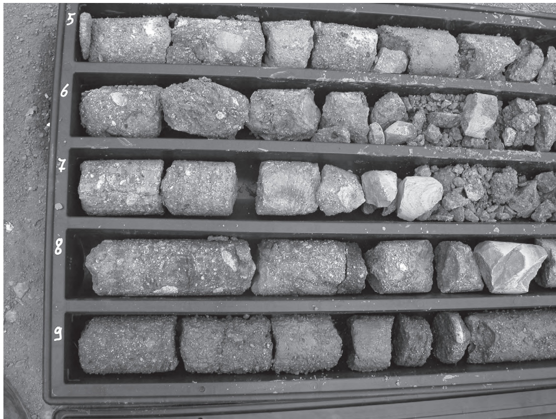
Fig. 5 - Aspetto di una cassetta in pvc con collocate all'interno le carote stratigrafiche del sondaggio (porzione corrispondente ai metri 5-10).
