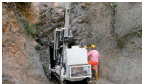
Carotaggio eseguito nel 2011 presso la Pesciara di Bolca per conoscere la successione delle rocce che si trovano sotto il giacimento fossilifero.
