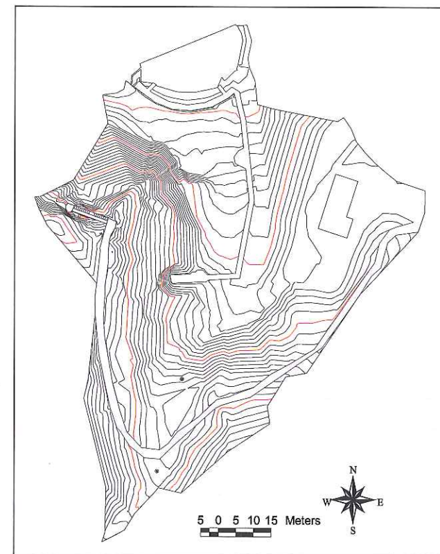
Fig. 4 – Pesciara: rilevamento topografico del tracciato realizzato per raggiungere l'ingresso della nuova galleria. (Progetto e direzione lavori: R. Zorzin)
